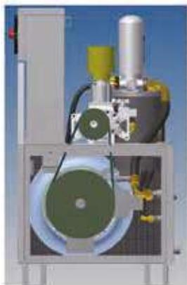
Sistema di tensionamento automatico della cinghia
